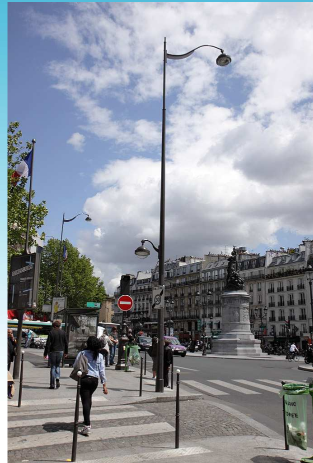
Fût classique et luminaire Decostreet fonctionnel avec retour piéton ( luminaire existant place de Clichy)
