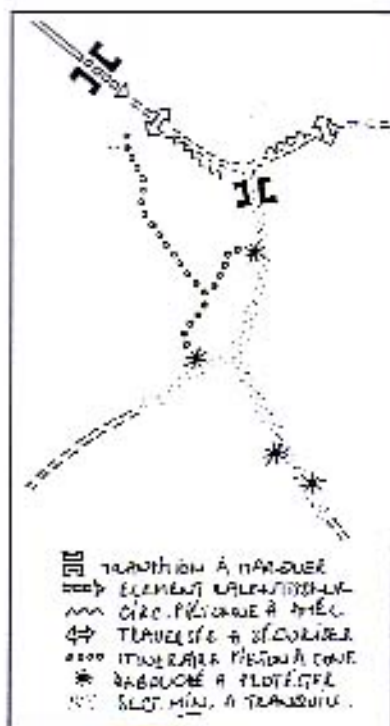
Sur la route cantonale à l'entrée du village, l'îlot assure le ralentissement avant le passage piéton. Les «bandes polyvalentes» améliorent la sécurité des piétons grâce à l'espace gagné sur la route. Les deux passages piétons sont mieux mis en évidence.
