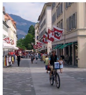
Poststrasse : le dallage posé au milieu de la rue permet de canaliser les cyclistes, qui préfèrent utiliser cette bande de circulation plutôt que de rouler sur les pavés.
