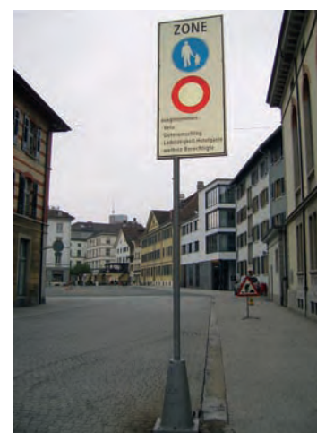
Winterthur : la zone piétonne n'est pas signalisée au moyen du signal officiel « Zone piétonne », mais par les signaux « Chemin pour piétons » et « Interdiction générale de circuler ». Trois exceptions à cette interdiction sont prévues : l'accès des cyclistes, la circulation pour charger/décharger des marchandises et celle pour accéder aux hôtels.
