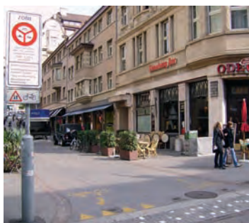
Zurich, Torgasse (vue depuis la quai de la Limmat) : l'accès des cyclistes est autorisé, mais l'aménagement en entrée les oblige à fortement ralentir.
