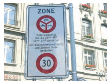
Berne, vieille ville : signal 2.14 accompagné d'une autorisation exceptionnelle. Le signal 2.14 ne donnant aucune indication sur la vitesse autorisée des véhicules admis, celle-ci doit être présentée de façon indépendante. La surface ainsi signalisée est une chaussée où le trafic motorisé est prioritaire.
