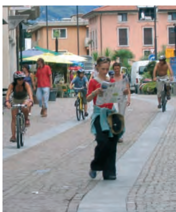
Ascona : dans ce secteur pavé, les deux bandes goudronnées permettent de canaliser les cyclistes, qui privilégient les revêtements offrant une faible résistance au roulement.
