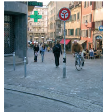
Zurich, Torgasse (vue depuis la Oberdorfstrasse) : séparation nette entre la chaussée et l'espace piéton (au premier plan sur la photo). La bordure biaise, les poteaux et le pavage contribuent à faire ralentir les cyclistes. Les poteaux empêchent aussi les véhicules de passer.
