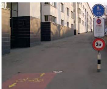
Zurich, Selnau : le revêtement de couleur indique aux piétons qu'il faut s'attendre à la présence de cyclistes.
