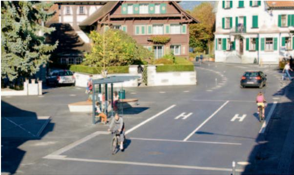
*Gestalterische Maßnahmen zur Errichtung der Begegnungszone in Hard umfassten: Verschmälerung der Fahrbahn, Rückbau des Zebrastreifens, Errichtung neuer Sitzgelegenheiten, Installation von Grüninseln, Aufbau eines Trinkbrunnens sowie Auflassung der Busbucht.*
