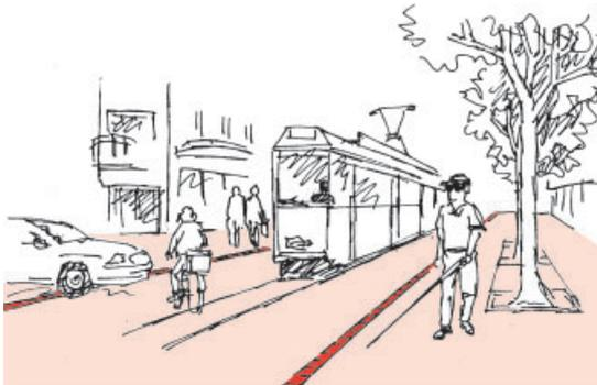
**Plates-formes des arrêts:** autant que possible de niveau avec le sol des véhicules (cf. 1.10.1). En outre, des lignes de guidage pour localiser les arrêts sont recommandées.
