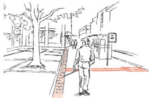
**Caniveaux:** les installer en tant qu'éléments de guidage, profondeur des rigoles équivalant au 1/15 de leur largeur, au min. 3 cm (cf. 2.5.2).
