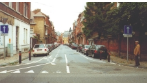
Un SUL (sens unique limité) permet aux cyclistes de circuler dans les 2 sens.
