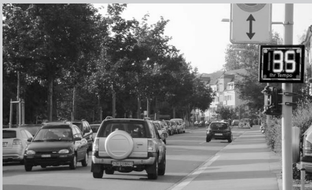
Das Speedy-Gerät zeigt die gefahrene Geschwindigkeit an und erinnert an die Tempo-30-Limite
