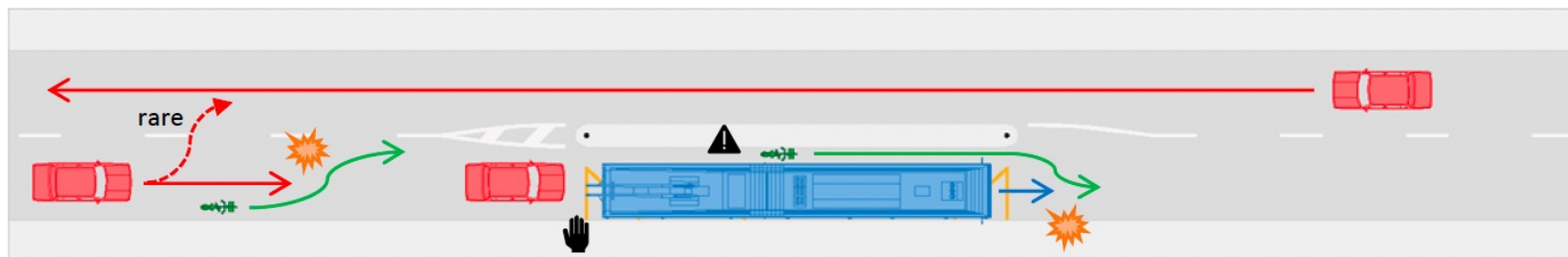
Figure 29 : Schéma de fonctionnement d'un arrêt bloquant
