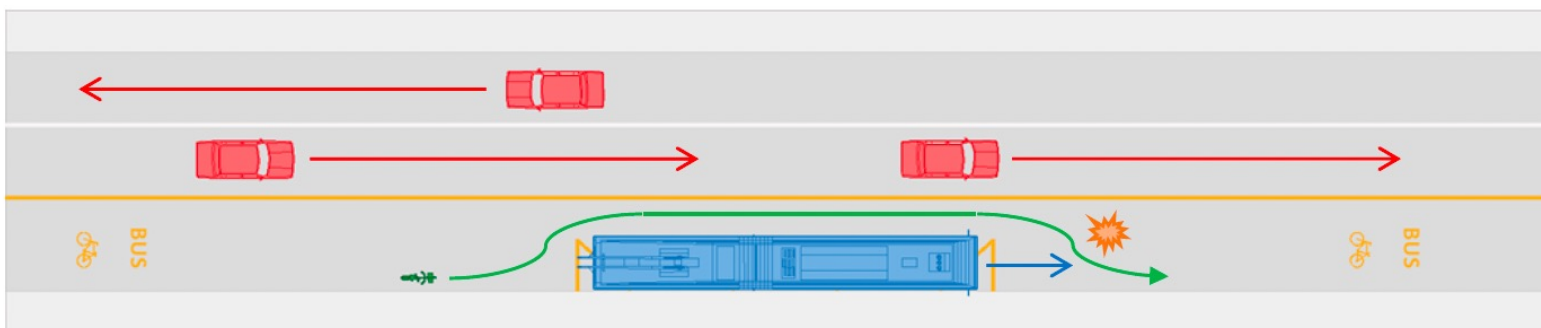
Figure 48 : Schéma de fonctionnement d'un arrêt de bus sur une voie mixte bus / vélo « étroite » Cas du bus précédant le cycliste
