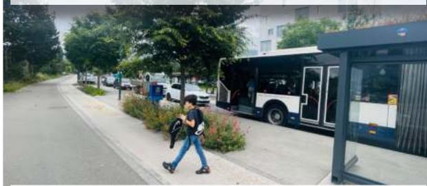
La piste cyclable passe derrière l'abribus permettant ainsi aux cyclistes de ne pas être stoppés dans leur progression.
