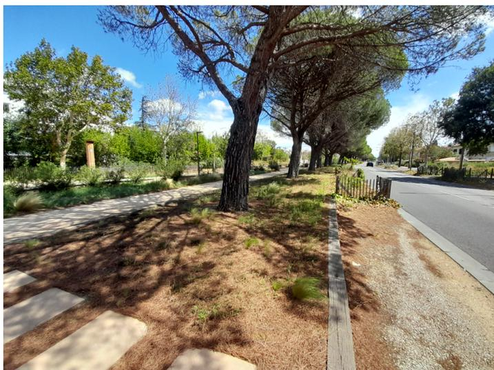
Illustration 35 : De petits passages sont aménagés pour rejoindre la bande longitudinale de stationnement revêtue d'un matériau perméable
