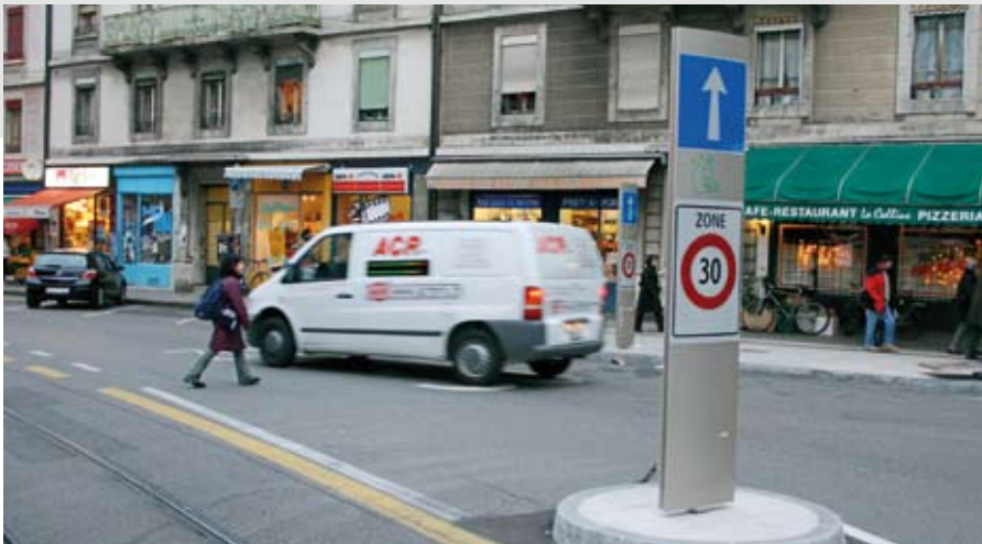
Rue de Carouge (à gauche, la voie du tram). Les piétons peuvent traverser partout en fonction de leurs besoins. Ici un coussin berlinois a été rajouté après coup (vers la camionnette). Photos: Alain Rouiller.
