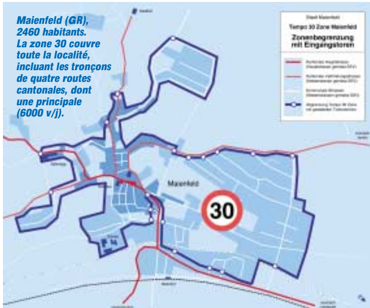
Les mesures sont légères: rétrécissement aux entrées, rétablissement de la priorité de droite aux carrefours, marquages au sol, pour un coût total (planification et réalisation) de 80 000 francs.
