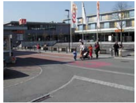
NEUENEGG (4400 hab.): traversée de localité, 6000 v/j, 50 km/h. Mesures: rétrécissement de la chaussée, changement de revêtement et marquages spéciaux, consignes pour les enfants, campagne d'information «Mitenand».
