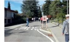
Entrée simple à mettre en œuvre en section courante : création d'une écusse équipée d'un lit avec le panneau d'entrée de zone, marquée au sol de « ZONE 30 » au niveau du rétroéclairage.
