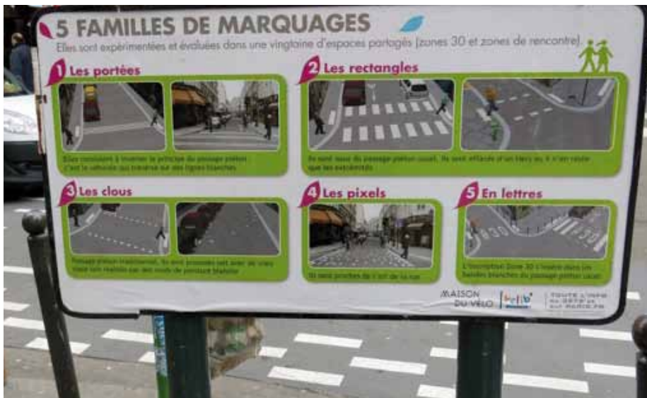
Projet-pilote pour les zones 30 et les zones de rencontre et test de cinq «familles de marquage». Avec les marquages en entrée de zone, puis des rappels à l'intérieur de la zone, l'usager sait de manière intuitive dans quel type de rue il se trouve. (Photo: A. Rouiller)
