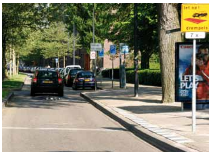
Amsterdam. Premier d'une série de sept coussins sur un axe transports publics, à l'entrée d'une zone 30.
