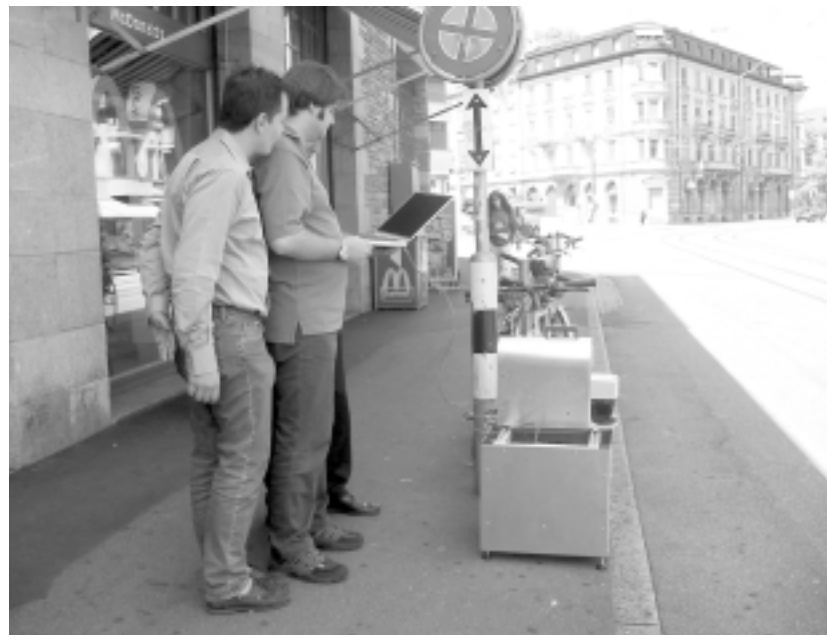
L'appareil laser compte et saisit tous les agents du trafic selon le type et la vitesse. A des fins de démonstration, un ordinateur portable a été connecté.
