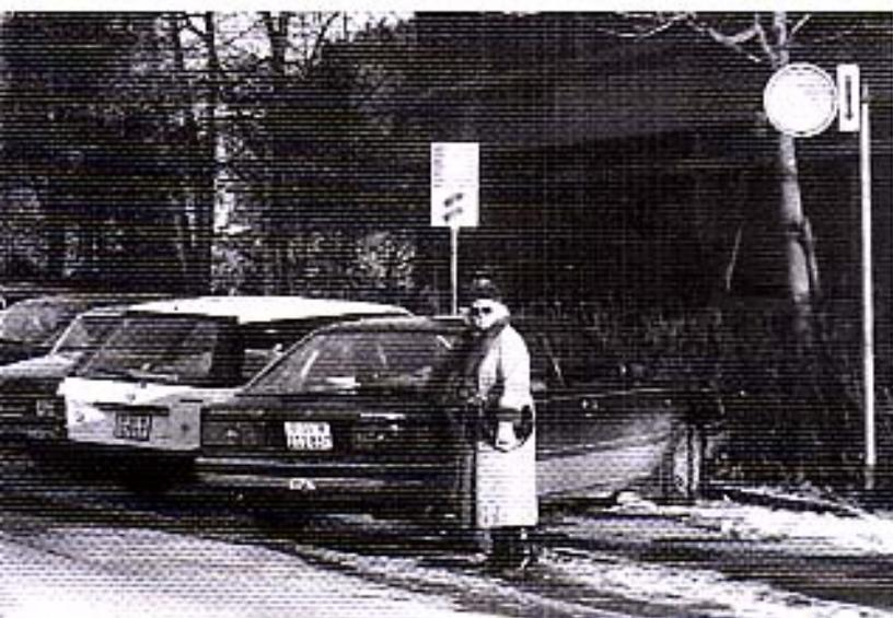
*Le trottoir s'interrompt au droit des places de parc. Pour gagner le trottoir d'en face, le piéton doit traverser la chaussée à un emplacement mal adapté, dépourvu de sécurité.*
