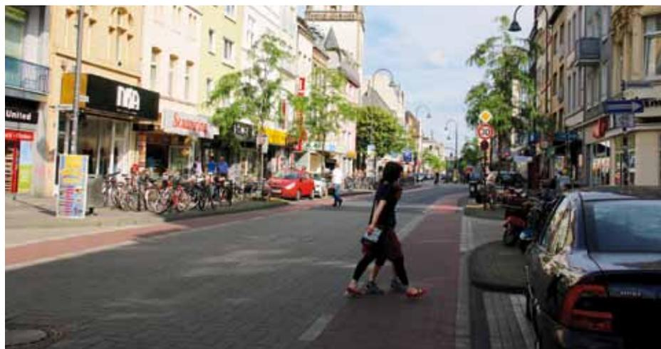
**A Cologne (D).** Exemple d'un tronçon d'axe important limité à 30 km/h, sans pour autant faire partie d'une «zone 30»: l'axe reste prioritaire, et la chaussée large permet la circulation des bus et des vélos sans conflit (Photo A. Rouiller)
