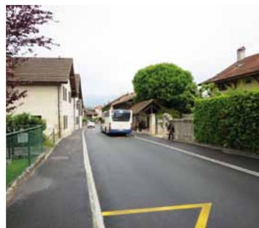
**Aire-la-Ville (GE).** Exemple de zone 30 dans un centre de village en traversée de localité. Une solution de détection des bus avec attente prolongée aux arrêts a permis de résoudre le problème de croisement dans le tronçon le plus étroit et en courbe. (Photo M. Walther)
