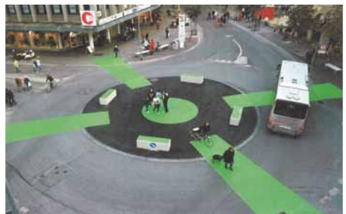
**Aménagement provisoire.** Le marquage routier a été effacé, remplacé par un marquage provisoire de couleur verte, qui introduit une transversalité et modifie la perception de l'anneau. Officiellement on ne se trouve plus à un giratoire, mais les conducteurs n'étant pas tout à fait au clair, ils se montrent prudents, ce qui contribue à la cohabitation. (Photo Ville de Coire)
