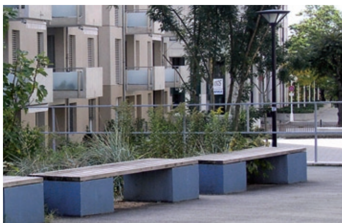
Exemple d'un banc inadapté car trop bas, sans accoudoirs et sans dossier.
