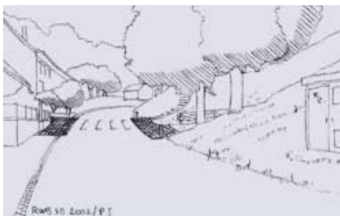
Traversée piétonne avec avancée ponctuelle du trottoir. Aménagement sur route cantonale principale, TJM 2000: 700 véh./jour.
