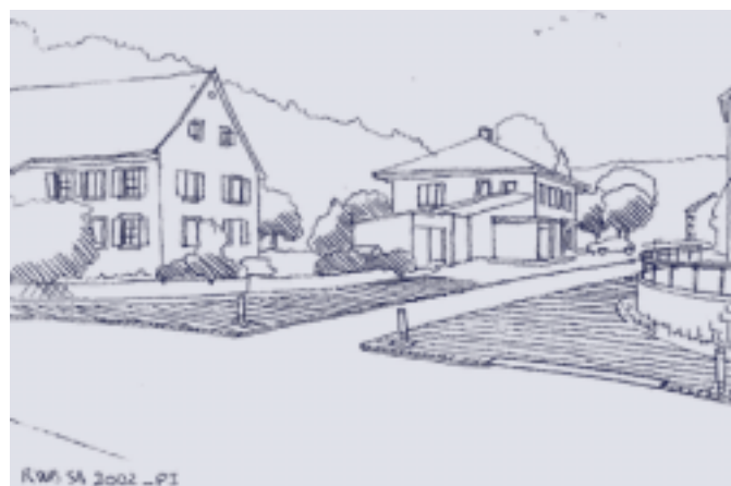
La mise en place de revêtements différenciés permet une lisibilité des espaces, notamment aux carrefours. Aménagement au croisement d'une route cantonale principale et d'une secondaire, TJM 2000: 800 véh./jour.
