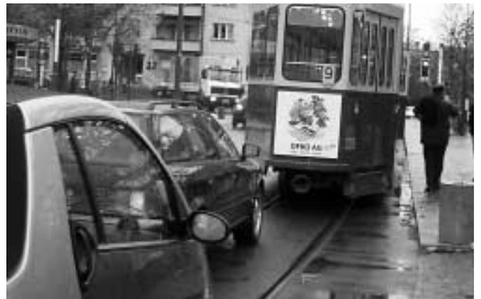
*Les voitures ne peuvent pas dépasser le tram. Néanmoins, la vitesse n'a que très peu baissé: de 31 à 28,5 km/h grâce à la suppression des feux et leur remplacement par des giratoires. La durée de la traversée de Wabern n'a augmenté que de 10 à 20 secondes dans le sens entrant et diminué dans la même proportion en sens sortant.*
