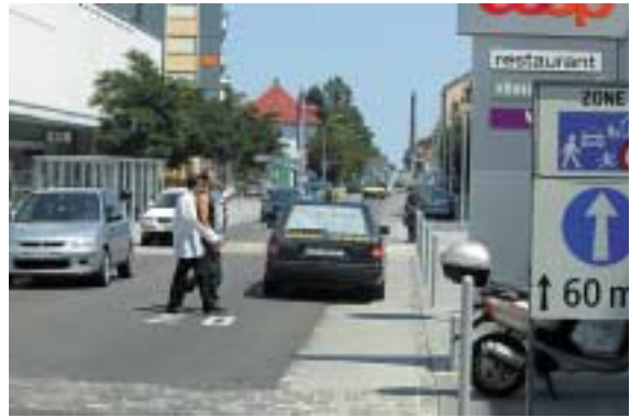
Granges. A la Solothurnstrasse, une zone de rencontre instaurée sur un tronçon de 60 m marque le croisement avec l'axe piétonnier reliant la gare à la place du Marché et remplace avantageusement l'ancien passage sous-voies.
